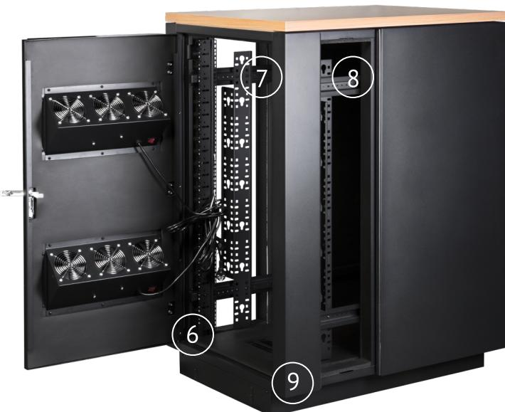
6. Шкаф предназначен для размещения 19" оборудования, с креплением на двух или четырех монтажных профилях. Возможна установка полок фронтального крепления и силовых полок, имеющих четыре точки крепления с монтажом на передние и задние профили. Направляющие выполнены из стали толщиной 2.0 мм и имеют нумерацию юнитов.
