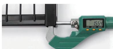
КАРКАС ПАНЕЛИ: стальной профиль 20x30 мм
